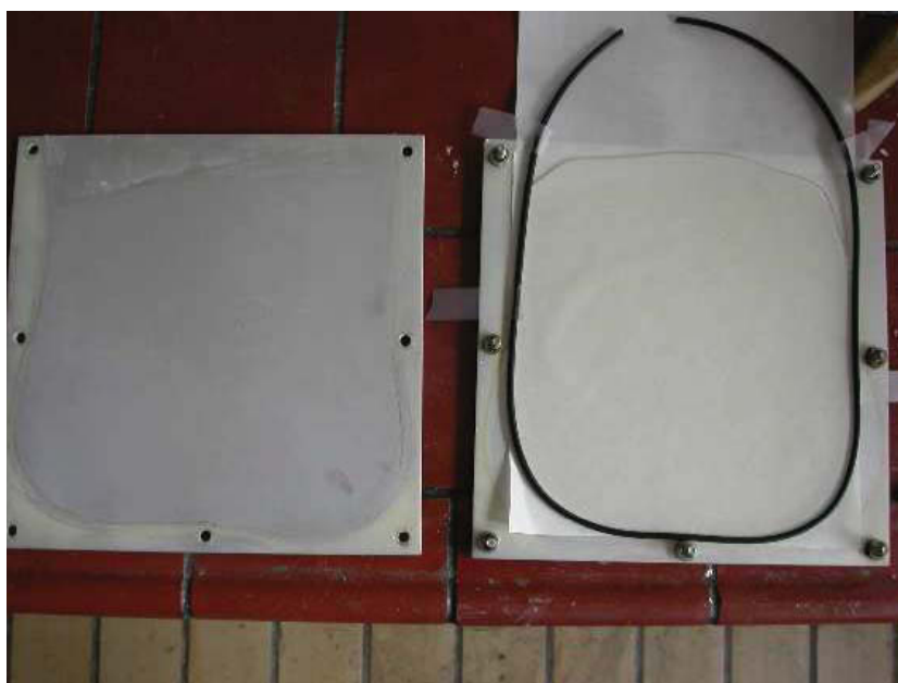
Abb. 3.1: Offene Aluminiumform mit Distanzschrauben und gehärteter Harzplatte inklusive O-Ring.
