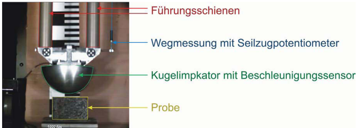
Abb. 4.13: Ausschnitt aus der Videoaufzeichnung des Impactversuch mit Kugelimpaktor (VNr. EPP40-K-01)
