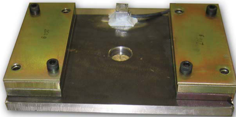
Abb. 3.5: Impaktor V1 mit Zusatzgewichten
