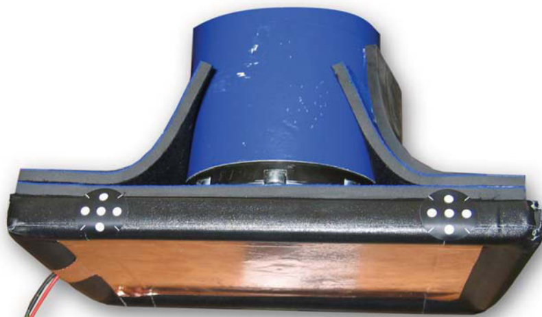
Abb. 3.6: Impaktor V2 mit Kontaktfolie, Neopren- und Gummilaschen auf der Abschussvorrichtung befestigt.
