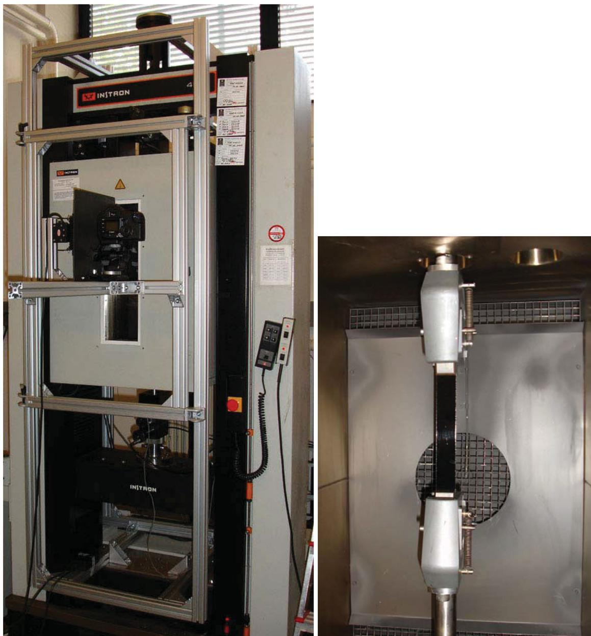
**Abb. 3.12:** Zugprüfmaschine mit aufgebautem Aluminiumrahmen (links); Einspannsituation der lackierten Blechprobe (rechts)
