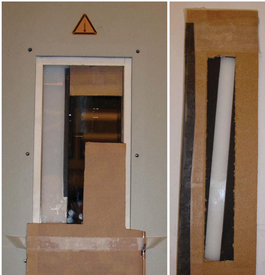
**Abb. 3.13:** Außenansicht der an der Temperierkammer befestigten Blende (links); Innenansicht der Blende (rechts)
