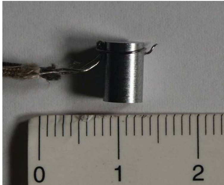
Abbildung 3.3: Unverformte Probe mit angebenem Thermoelement. Fertig zum Einbau in das Umformdilatometer
