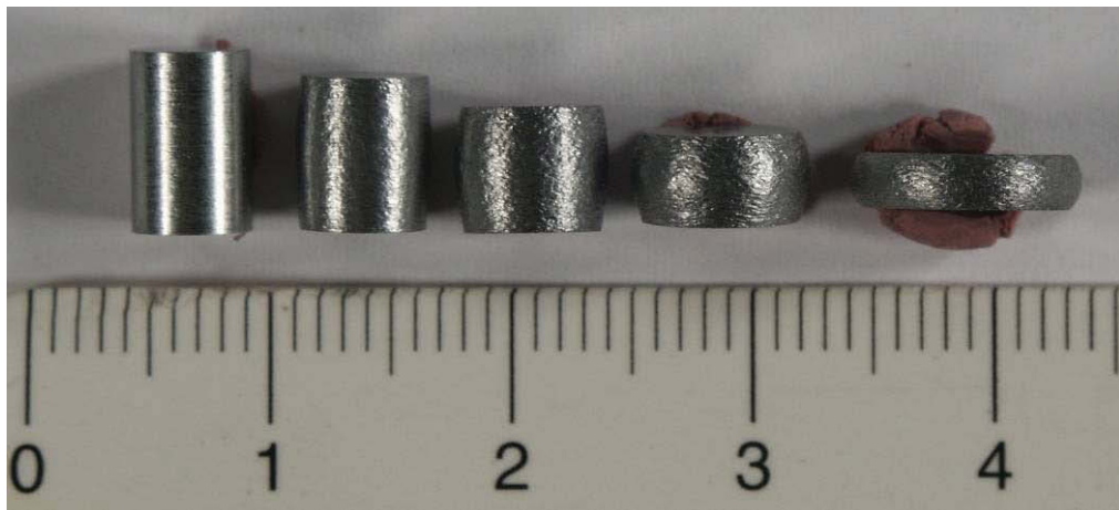
Abbildung 4.6: Proben mit einer Ausgangsgeometrie von \varnothing 5 mm x 7,5 mm mit unterschiedlicher Stauchverformung (von links: 0%, 15%, 30%, 50%, 70%). Bei diesen Proben ist eine gleichmäßige Ausbauchung der Mantelfläche zu erkennen.
