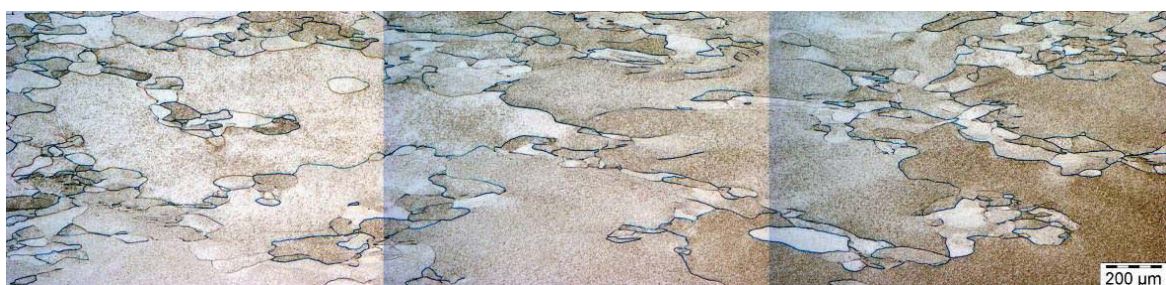
Abbildung 4.9: Probe mit 30% Stauchung und 1050°C/1h. Vergleiche mit den dazu korrespondierenden Abbildungen aus dem Anhang zeigen eine auffallend große rekristallisierte Korngröße.
