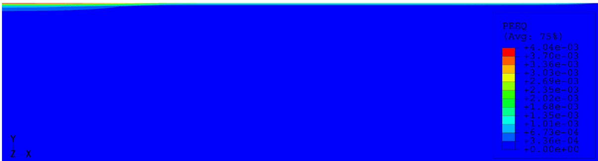
Abbildung 4.29: Akkumulierte plastische Dehnung einer unbeschichteten Probe nach Versuchsende
