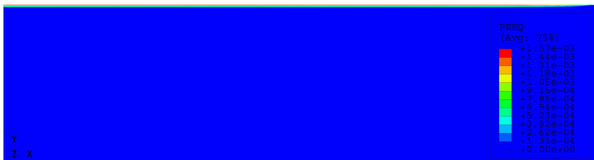
Abbildung 4.27: Akkumulierte plastische Dehnung einer unbeschichteten Probe nach Einbringen der Eigenspannungen
