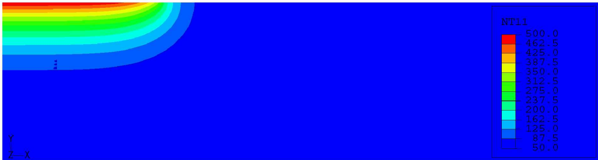
Abbildung 4.6: Temperaturfeld einer regional laserbestrahlten unbeschichteten Probe am Ende des Heizzyklus
