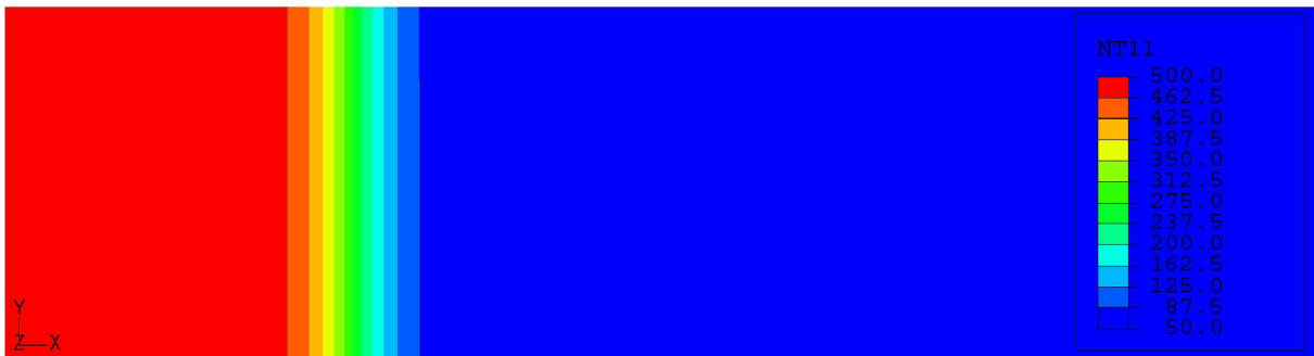
Abbildung 4.16: Temperaturfeld einer unbeschichteten Probe: Temperaturverlauf in x-Richtung entspricht dem Temperaturverlauf in x-Richtung an der Oberfläche der Probe aus Abbildung 4.7
