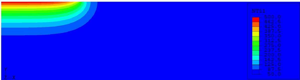
Abbildung 4.7: Temperaturfeld einer regional laserbestrahlten beschichteten Probe am Ende des Heizzyklus
