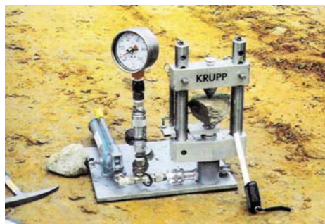
Abb. 69: Tragbares Prüfgerät zur Bestimmung der Materialfestigkeit
