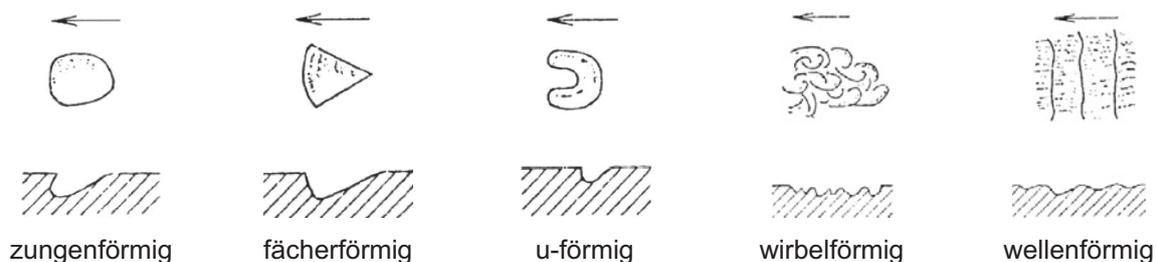
Abbildung 34: Erscheinungsformen der Erosionskorrosion <sup>[6]</sup>
