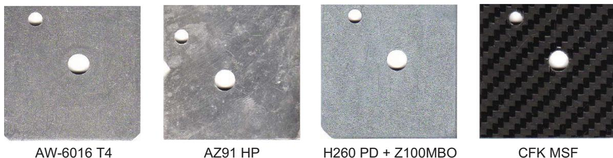
Abbildung 45: Probepfättchen der einzelnen Werkstoffe
