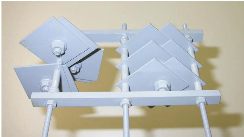
Abbildung 46: Probenträgersystem für den Beschichtungsvorgang
