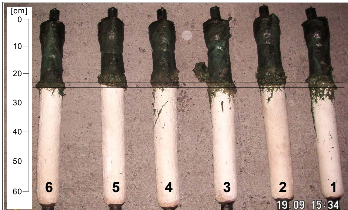
Abbildung 4-26: Eintauchtiefen der Sonden - Versuch 2
