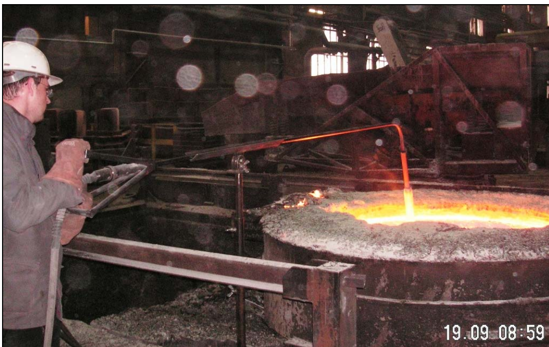
Abbildung 4–22: HydroVAS-Messung mit Stativ
