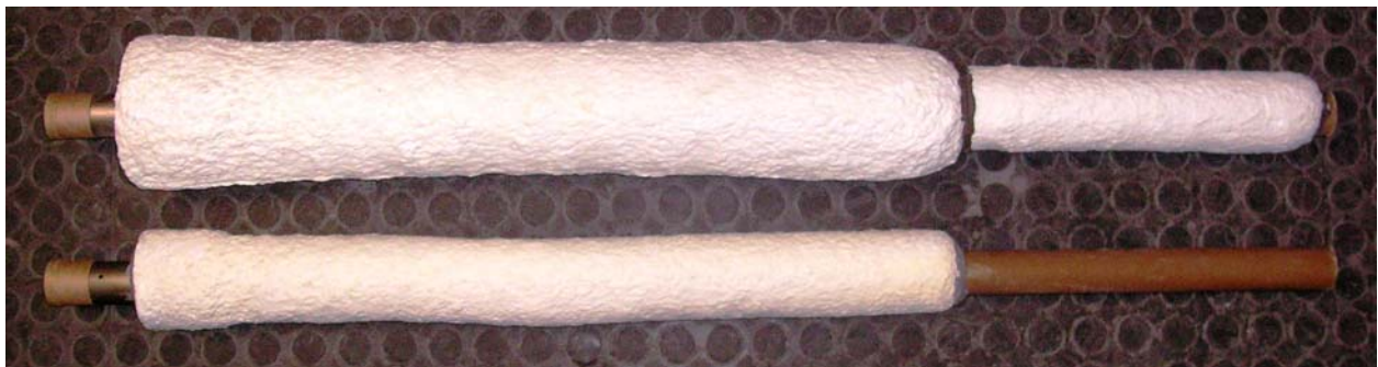
Abbildung 4–50: Vergleich von Standardsonde und Langzeitsonde
