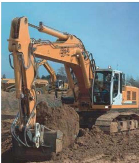
**Abbildung 37: hydraulischer Tieflöffelbagger**
