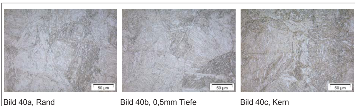
Abbildung 40: Lichtmikroskopische Aufnahmen im Randbereich und im Kern einer nach den Prozessparametern der Serie E aufgekohlten C4+Nil Probe, Kalling II Ätzung.
