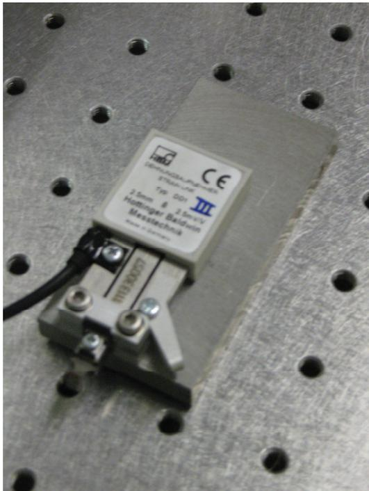
Abb. 4.1: Darstellung eines DD1 Wegaufnehmers von HBM.
