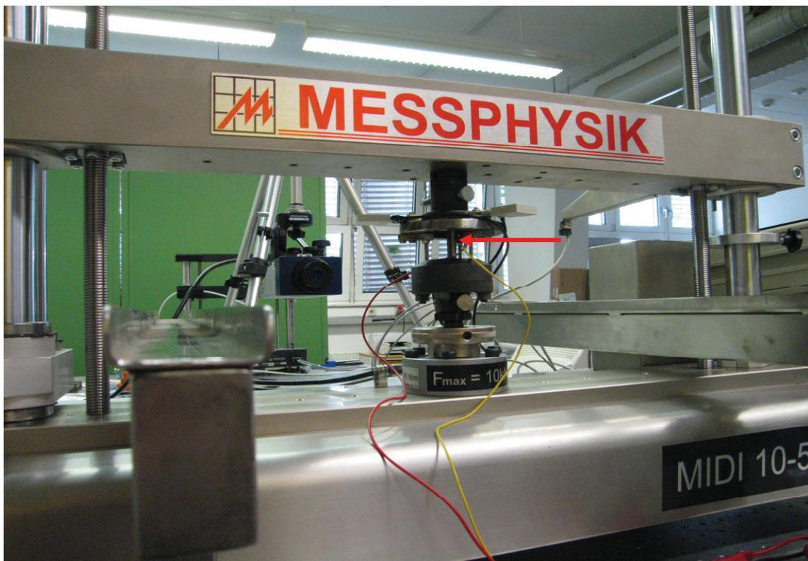
*Abb. 4.15: Versuchsaufbau zur Messung der relativen Verkipfung des Oberstempels und der Querverschiebung des Stacks (roter Pfeil). Im Hintergrund ist auch der Messkopf des Laservibrometers mit dem dazugehörigem Stativ zu erkennen.*
