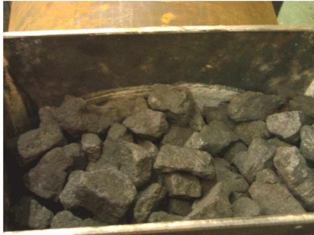
Abbildung 5.14: Über die Oberkante des Rohrs hinausragende Koksstücke führen zum Verklemmen der gesamten Koksschüttung
