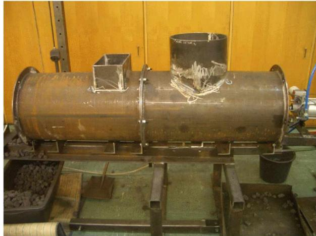
Abbildung 5.9: Versuchsstand für die Koksförderung
