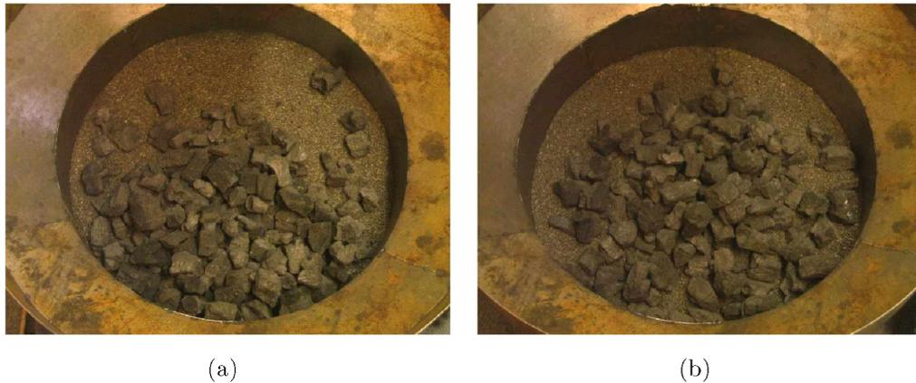
Abbildung 5.8: Ergebnisse zur Koksverteilung bei einer Abwurfhöhe von 54 cm in Abb. 5.8(a) und 40 cm in Abb. 5.8(b)
