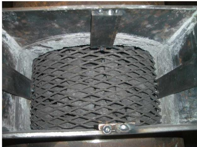
Abbildung 5.15: Gasabzug mit eingebautem Metallgitter
