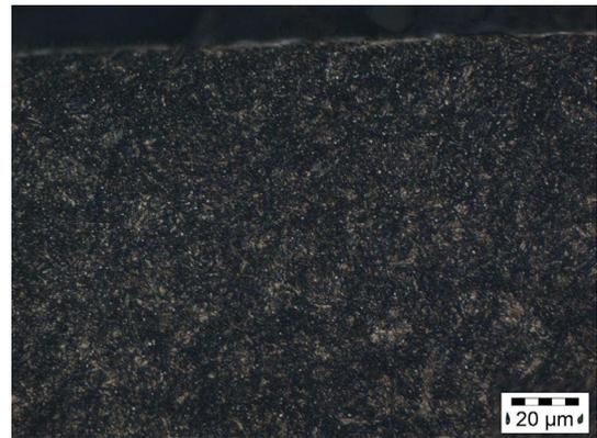
**Abb. 80:** Randgefüge: W360 – UDAK: Martensitische Grundstruktur
