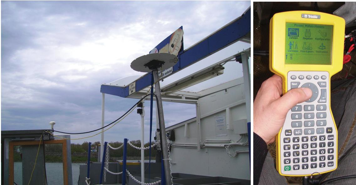
Abb. 25: Anschlüsse: Gelbes Kabel: GPS, Schwarzes Kabel: Echolot; Kontrolleinheit
