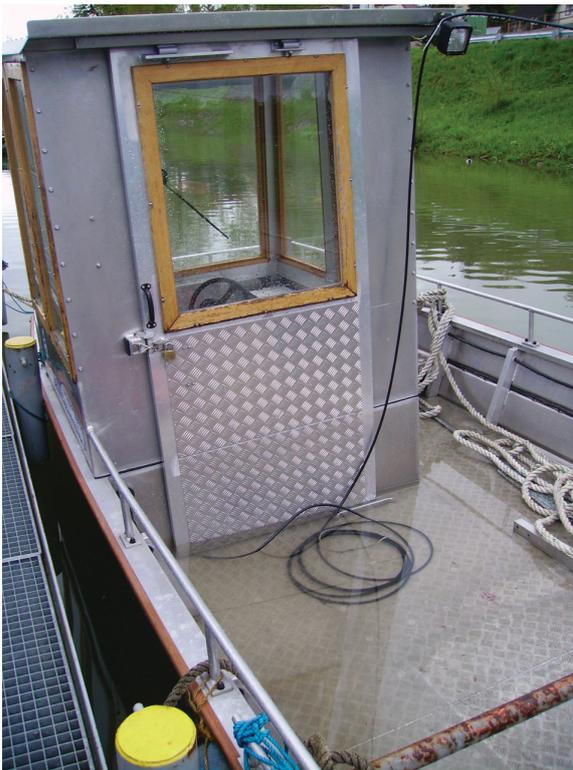
Abb. 31: Unzureichender Wasserabfluss am Messschiff
