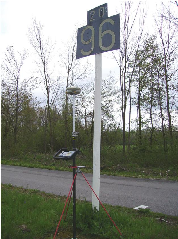
Abb. 33: Roversystem mit Trimble 5800 und ACU-Controller
