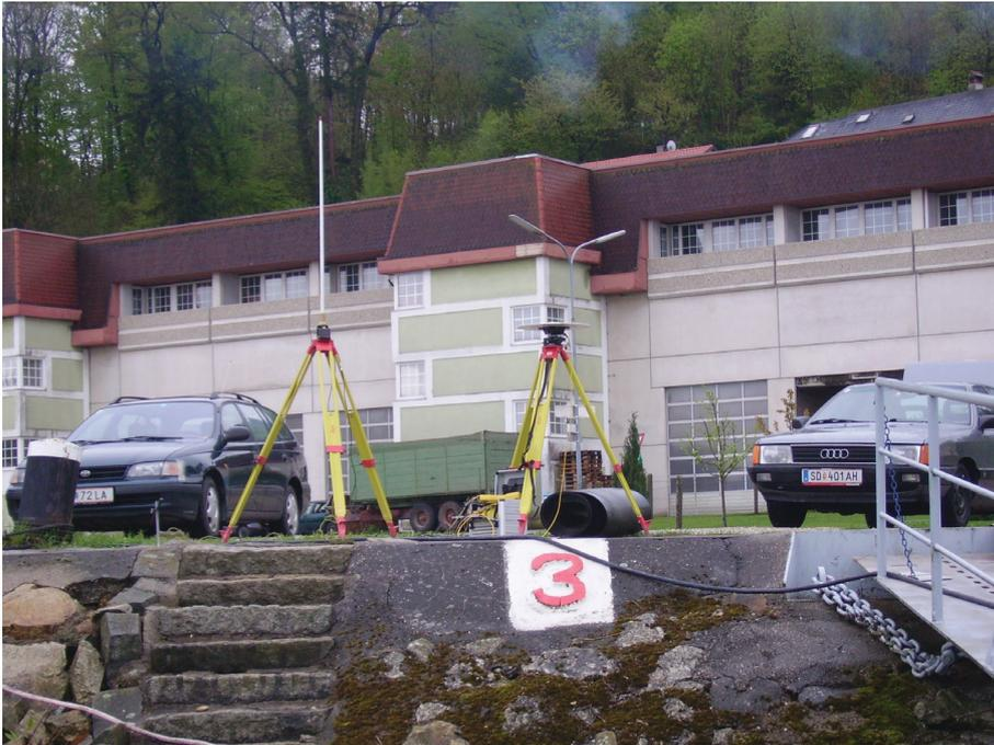
Abb. 29: Telemetrieantenne und Referenzstation
