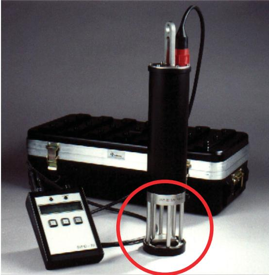
Abb. 11: Schallgeschwindigkeitssonde SVP 14/SVP 15, durch roten Kreis gekennzeichnet: fest definierte Distanz  $D$ , vorgegeben durch eine Metallplatte
