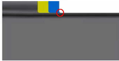
Abbildung 11.3: Der Schnitt mit der perfekten Schneide mit sehr kleinem Eckenradius
