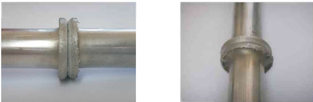
Abbildung 9.4: Reibschweißverbindung zweier Aluminiumprobekörper: Die Abbildung zeigt die materialschlüssige Pressschweißverbindung von zwei beim Probeversuch verwendeten Probekörpern der Legierung AA6082 unmittelbar nach dem Fügeschritt.
