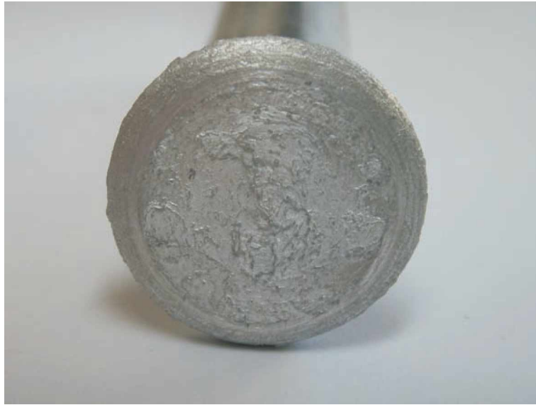
Abbildung 9.6: Fügefläche einer Reibschweißverbindung: Nach dem durchgeführten Zugversuch zeigte sich die Fügefläche an den getesteten Materialproben, wie hier repräsentativ an Probe Nr.1 (siehe Tabelle 9.1) dargestellt.
