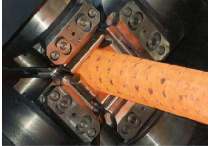
Abbildung 2: Radialschmieden des Vormaterials [23]
