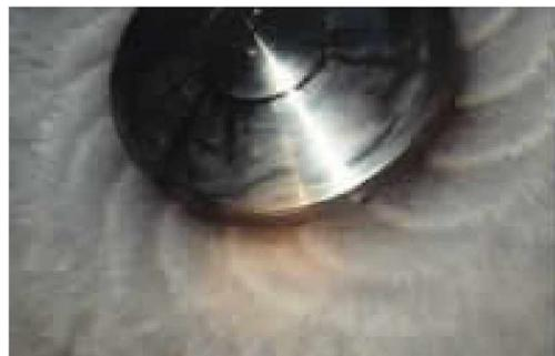
Abbildung 19: Aufnahme des „Atomizers“, der Firma Hamon Research Cotrell, der zur Zerstäubung der Kalkmilch verwendet wird
