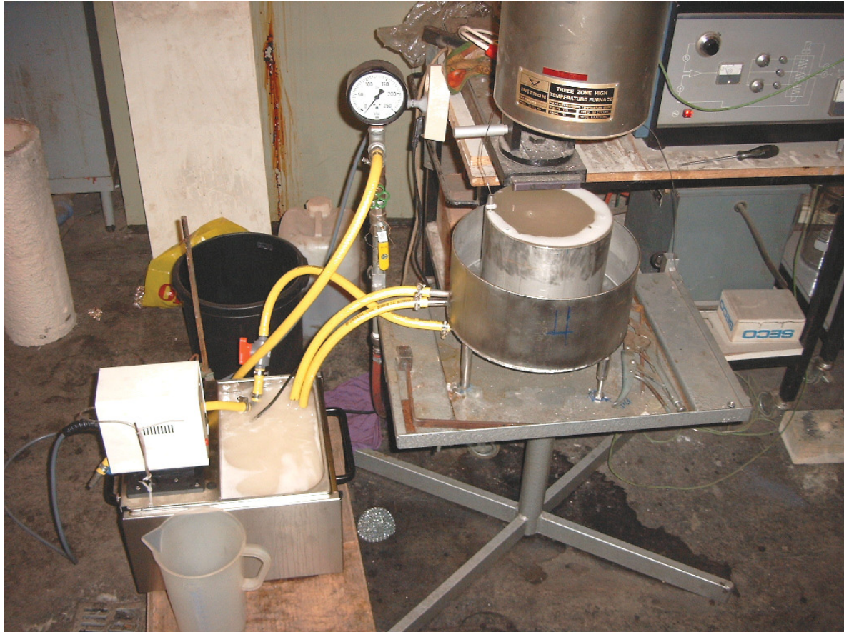
Bild 3.4: Abschreckanlage Quenchomat mit Ausgleichsbehälter und Thermostat
