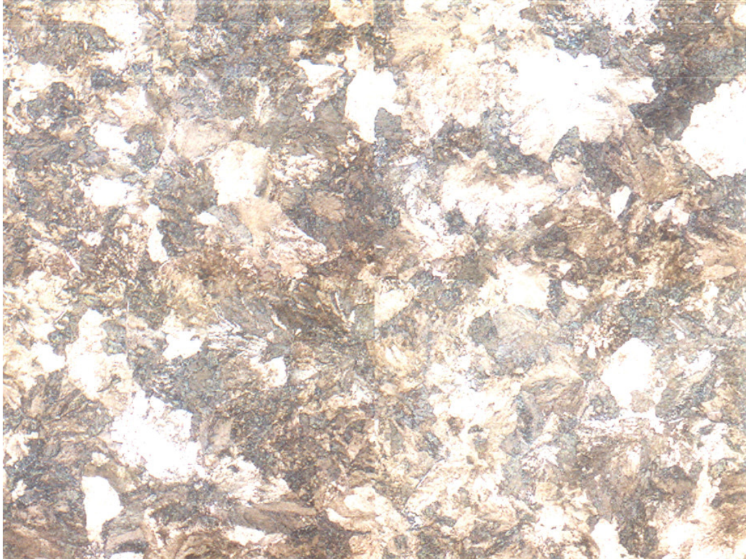
Bild 2.15: Gefügebild einer feinperlitischen Schiene (400fach, \text{HNO}_3 )
