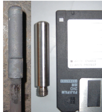
Bild 3.3: Prüfkörper links und Größenvergleich Probe-3 ¼ “ Diskette rechts [21]
