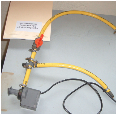
Bild 3.5: Pumpe mit Mengenregelung
