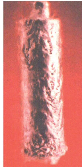
Bild 2.23: Schema und reales Bild der Dampfhaut
