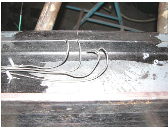
Bild 3.9: Schienenstück mit Thermoelementen
