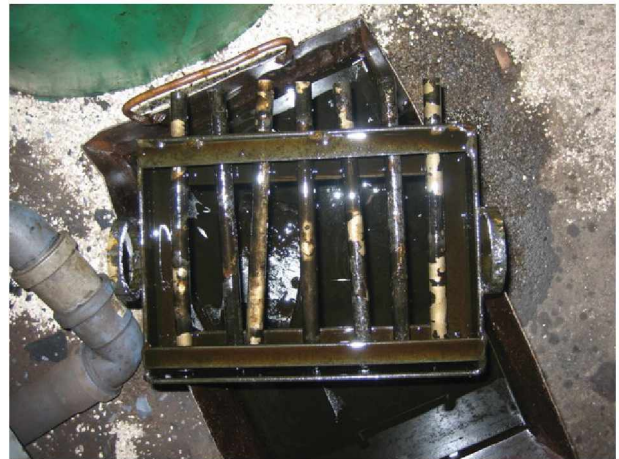
B) Gehärtete Proben in Probenhalterung
