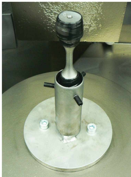
Abb. 3.7: Probenhalterung beim Kugelstrahlen
