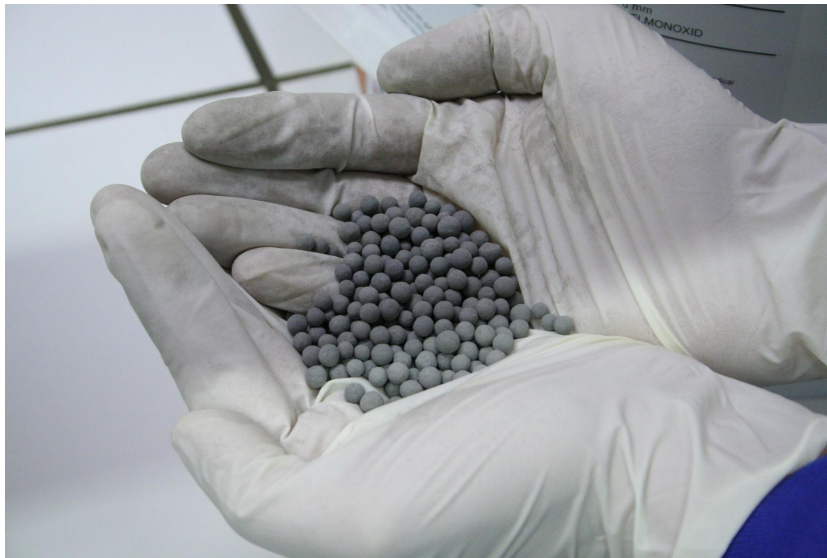
Abbildung 3.6.: Kugelförmiger Katalysator Meth134 ® (C13-4-04) von C&CS catalysts & chemical specialties
