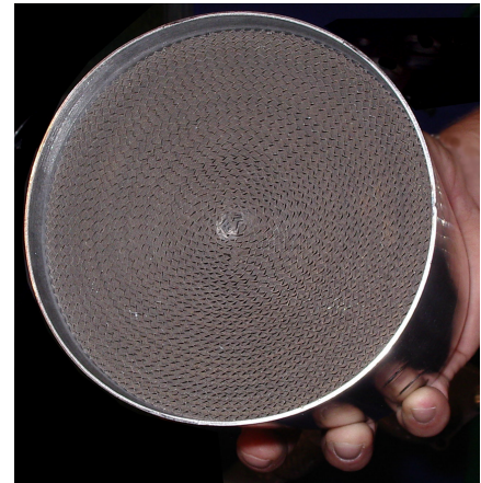
(b) Metallwabenkatalysator in einfacher Spiralwicklung [187]
