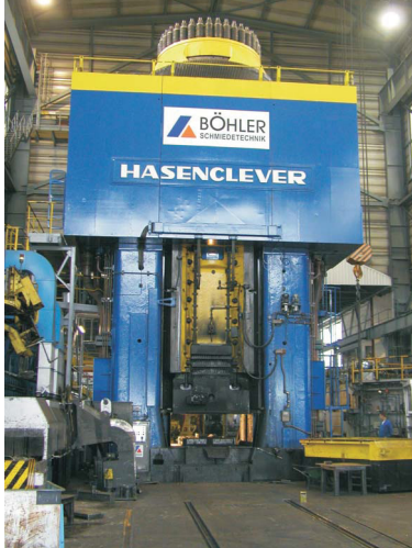
Abbildung 4.4: Die Schwungradspindelpresse mit Hydromotoren der Maschinenfabrik Hasenclever GmbH war mit einer Prellschlagkraft von 31.500 Tonnen lange Zeit die größte der Welt.
