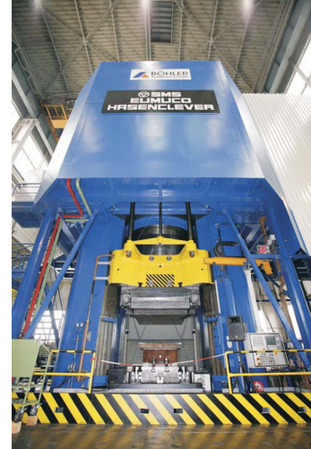
Abbildung 4.5: Die Kupplungsspindelpresse SPKA 22.400 der Firma SMS Eumoco. Die Presse ist mit einer Prellschlagkraft von 35.500 Tonnen die größte Spindelpresse der Welt.
