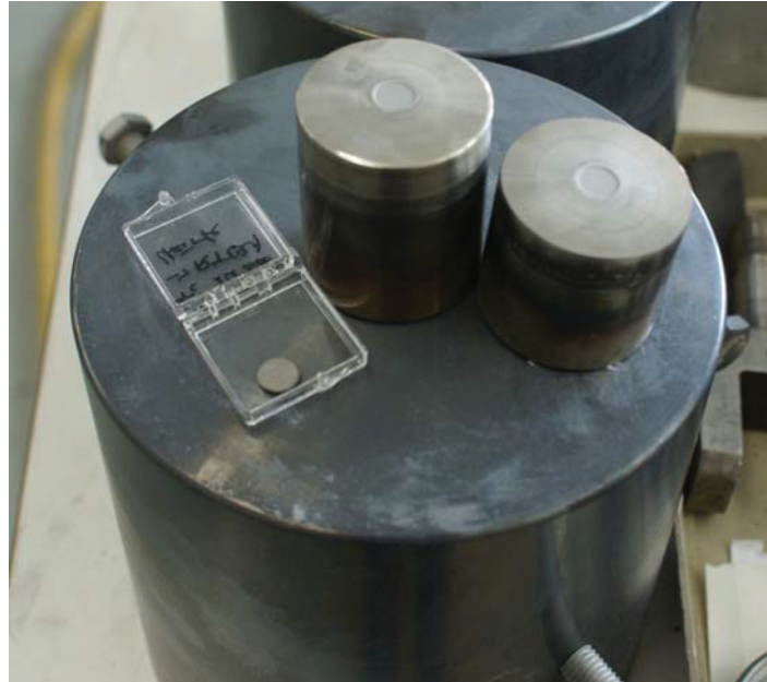
Abbildung 4.2: Sandgestrahlte Stempel und Probe
