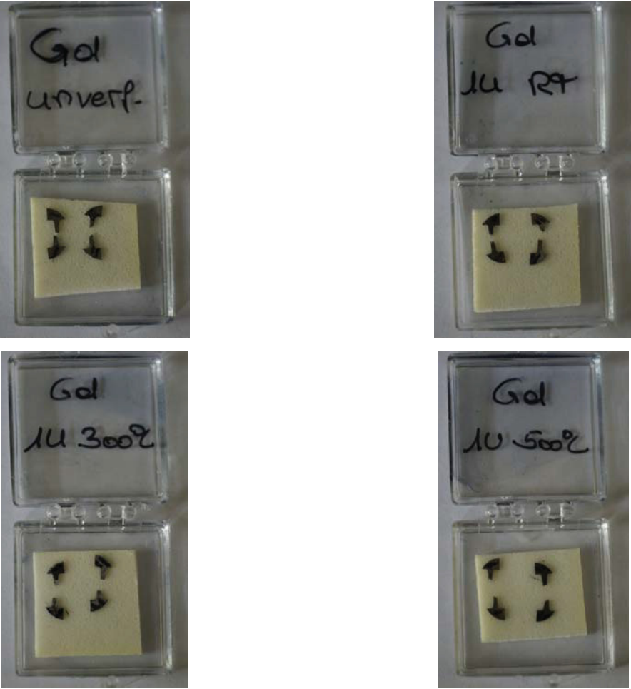
Abbildung 7.30: Seitenansicht der Zugproben von Gadolinium
