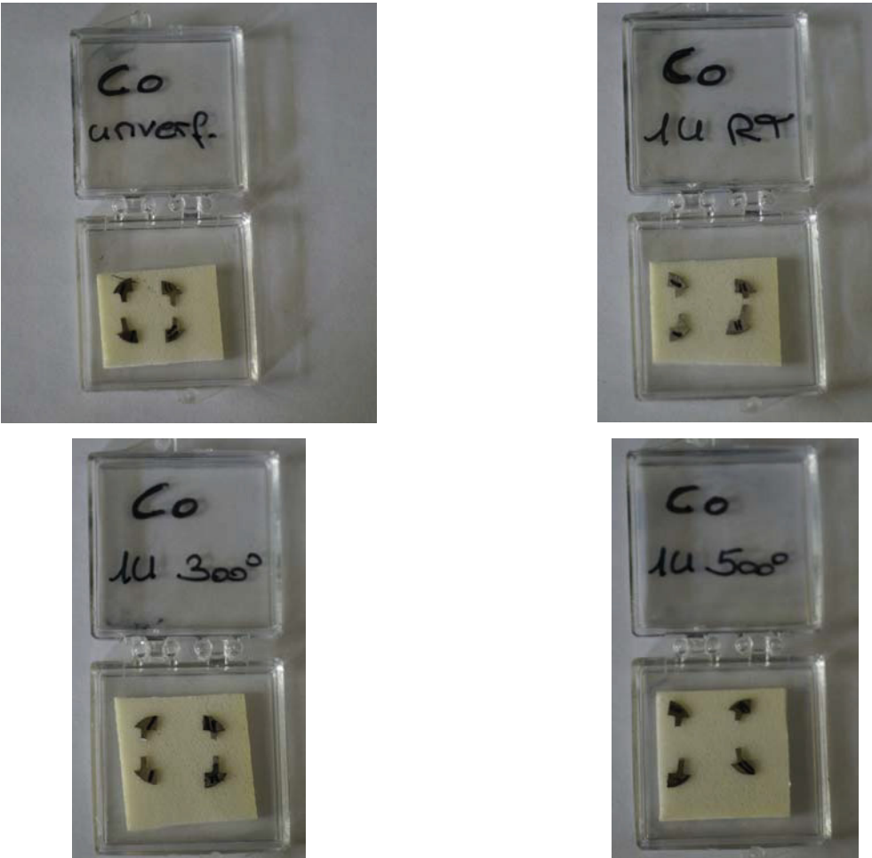
Abbildung 7.29: Seitenansicht der Zugproben von Kobalt
