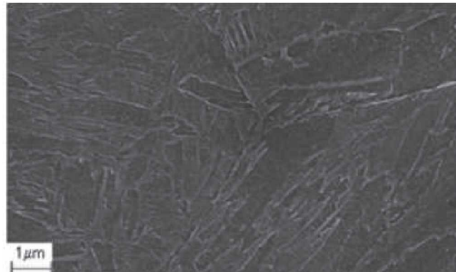
Abbildung 2.8: Martensitisches Gefüge eines X38CrMov5-1 Warmarbeitsstahls nach dem Härten mit einem Abkühlparameter \lambda = 0,6 [11].
