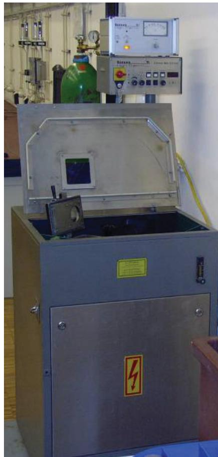
Abbildung 11: Hochfrequenz-Ofenanlage
