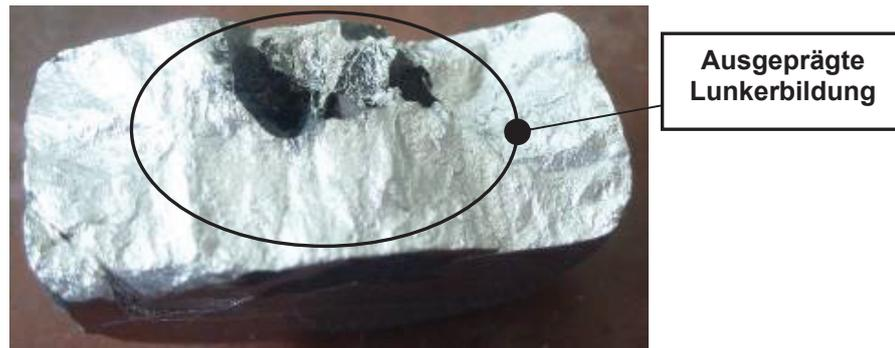
Abbildung 14: Bruchfläche einer Umschmelzprobe
