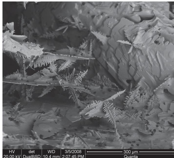
Abbildung 16: Dendritisches Erstarrungsgefüge
