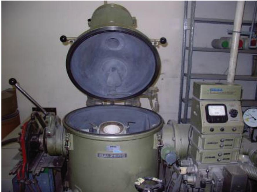
Abbildung 9: Vakuuminduktionsofen
