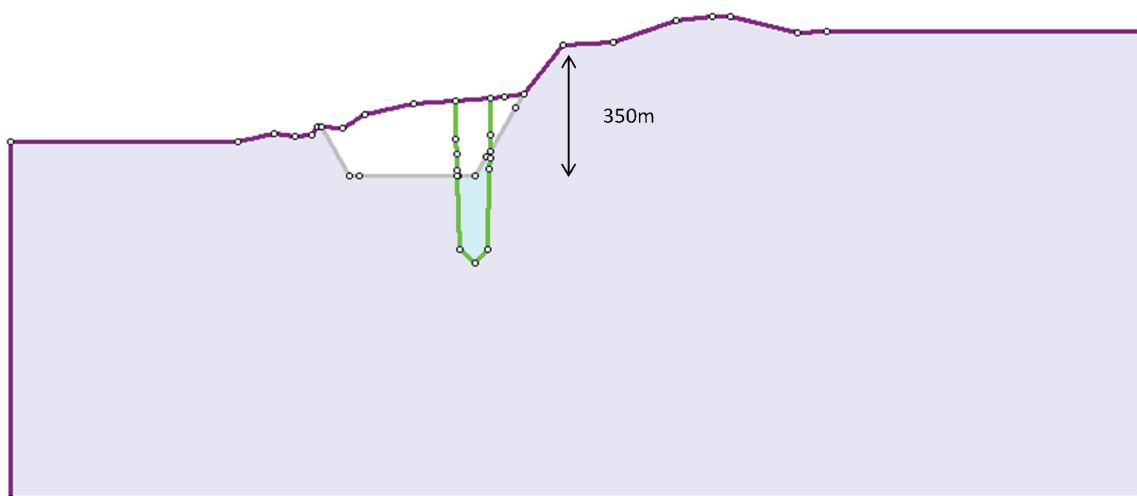
Abbildung 21: Tagbau mit 60° Generalneigung am Beispiel des kritischen Schnitts 1
