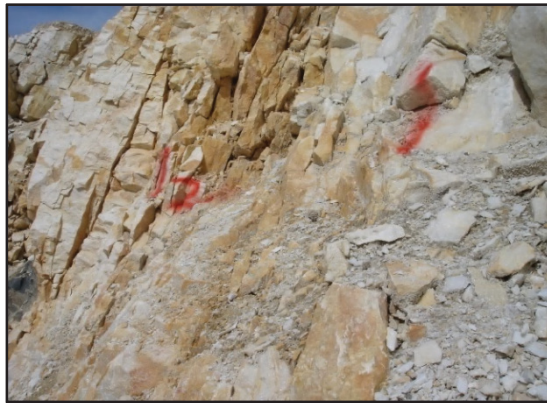
Abbildung 35: geotechnischer Homogenitätsbereich 2, GSI=55
