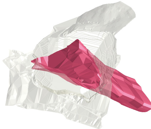
Abbildung 23: 3D- Darstellung der Schichten die möglicherweise untertägig abgebaut werden könnten
