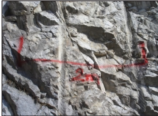
Abbildung 34: geotechnischer Homogenitätsbereich 1, GSI=65
