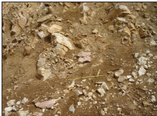
Abbildung 36: geotechnischer Homogenitätsbereich 3, GSI=30
