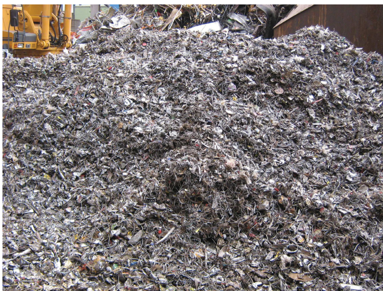
Abbildung 10: Magnetschrott nach dem 2. Durchgang mittels Zerdirator
