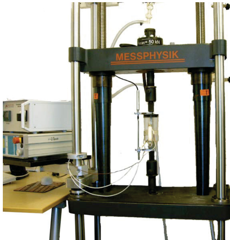
Abb. 3.4: Übersichtsaufnahme der verwendeten SSRT– Prüfanlage
