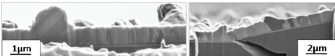
Abb. 40: FIB-Schnitte zum Sichtbarmachen der Kornstruktur in einer 1000nm Schicht des Systems A
