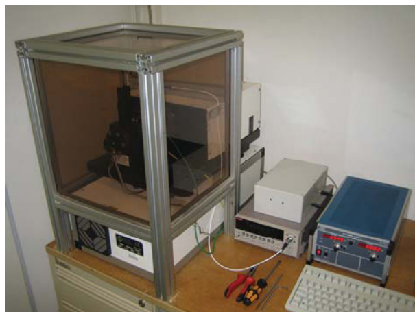
Abb. 4.2: Rumul Cracktronic Resonanzprüfmaschine zur Rissfortschrittsmessung
