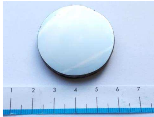
Abbildung 24: Makroskopische Aufnahme der geschliffenen und polierten Scheibe eines HIP-Materials. Durch den HIP-Prozess wurde ein makroskopisch porenfreies und rissfreies Gefüge hergestellt.
