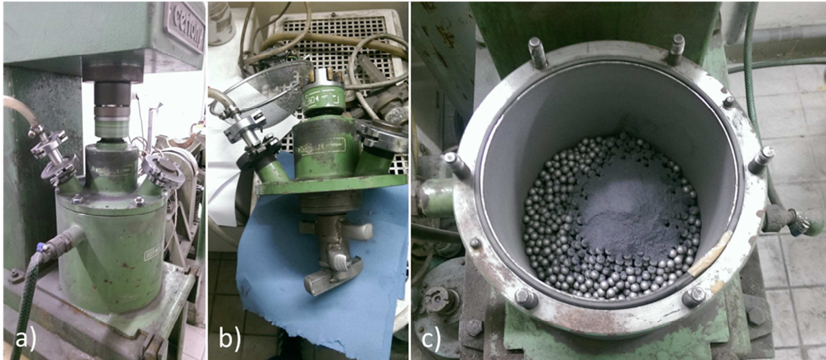
Abbildung 17: a) Laborattritor im Einsatz, b) Gefäßdeckel mit der Durchführung für den Rührer sowie der Ar-Gaszufuhr, c) Mahlgefäß mit Mahlkugeln und der Pulvermischung vor dem Mahlvorgang.
