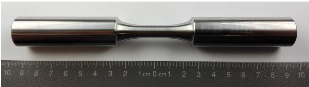
Abbildung 20: Verwendete LCF-Probengeometrie für Zugversuchsuntersuchungen.
