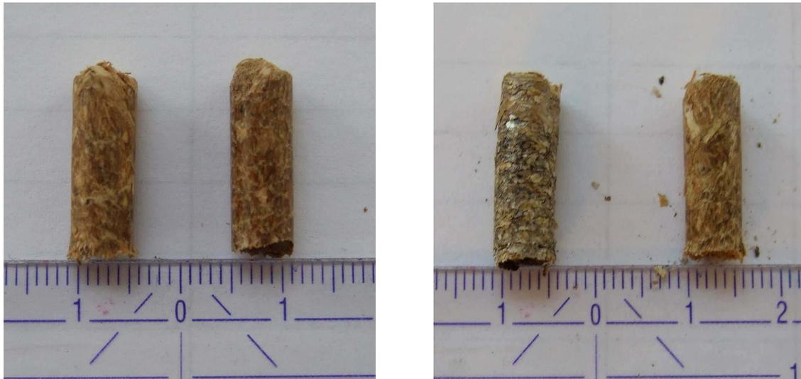
Abbildung 14: Links maschinell gepresste Weizenstrohpellets der Firma Meyer und rechts die händisch gepressten
