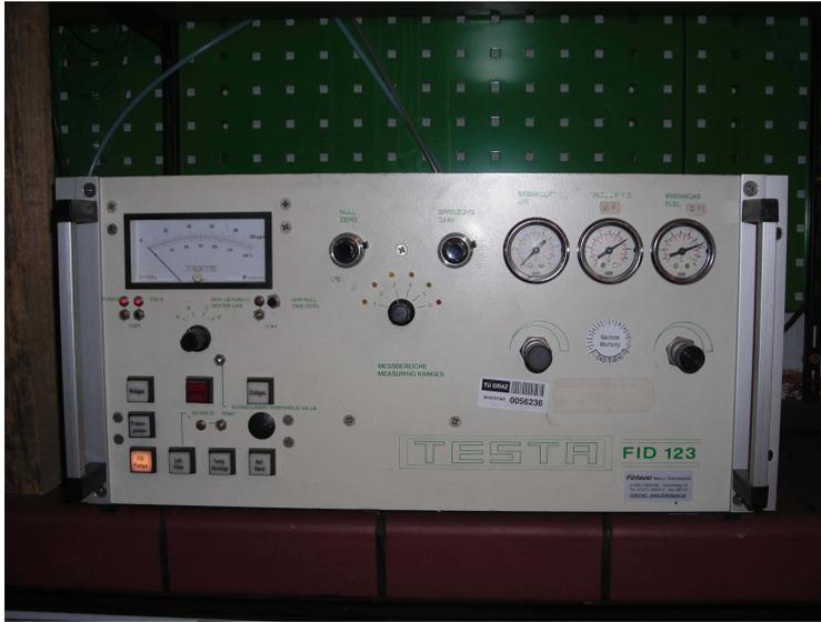
Abbildung 11: Flammenionisationsdetektor (TESTA FID 123)
