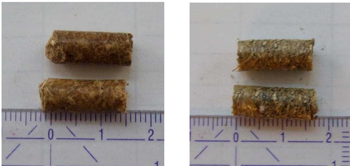
Abbildung 13: Links maschinell gepresste Weizenstrohpellets der Firma Meyer und rechts die händisch gepressten.
