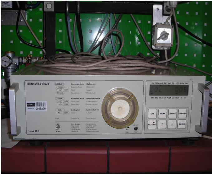
Abbildung 10: CO / CO<sub>2</sub> Analysator (URAS 10E)
