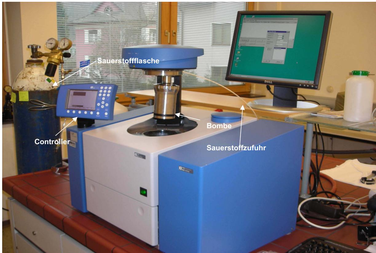
Abbildung 24: IKA Bombenkalorimeter
