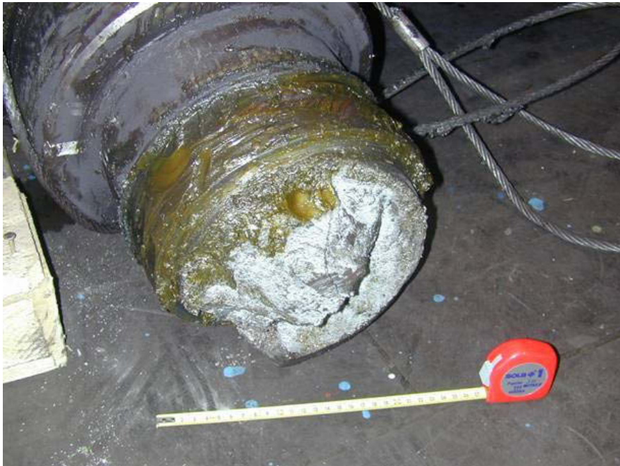
Abb. 1.4: Bruch einer Arbeitswelle am Lagerpunkt
