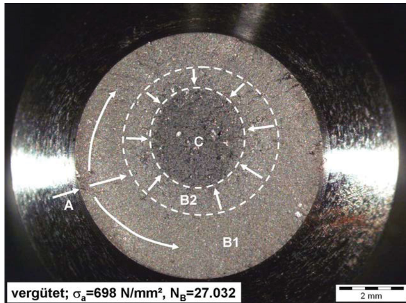
Abb. 8.10: Bruchfläche der gekerbten, vergüteten Umlaufbiegeprobe
