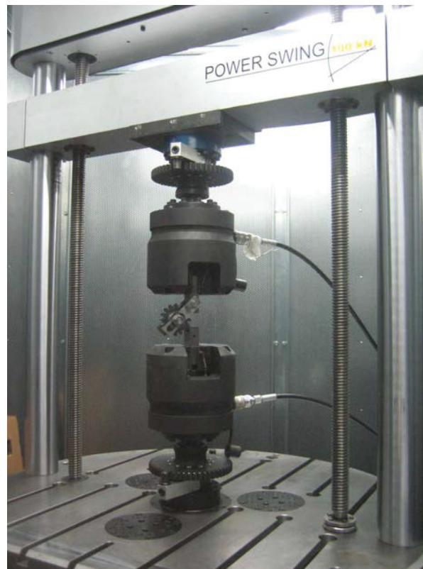
Abb. 7.8: Die verwendete Resonanzprüfmaschine während eines Versuchs mit dem Ritzel im Labor des Lehrstuhls
