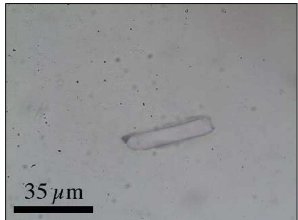
Abb. 5-98 Anhydriteinschluss im Diopsid
