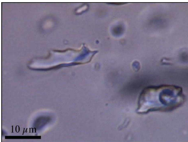
Abb. 5-7 FIs mit und ohne Gasblase
