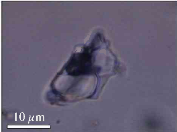
Abb. 5-54 Komplexer, mehrphasiger Einschluss im Quarz
