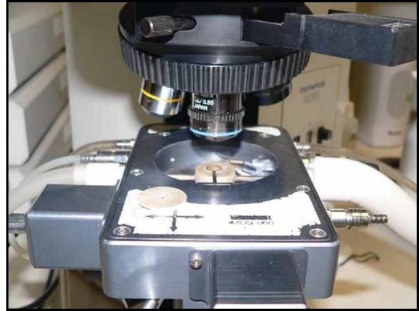
Abb. 3-6 Detailaufnahme des Heiz- Kühltisches (LINKAM MDS 600)
