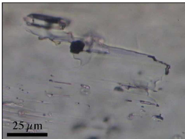
Abb. 5-12 Fester Aktinoliteneinschluss mit Hämatitphase (schwarz) im Diopsid
