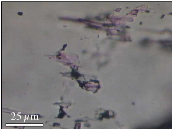
Abb. 5-14 Fester Aktinolitheinschluss mit Hämatitphase (schwarz) im Diopsid
