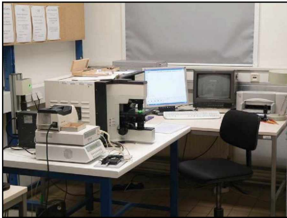
Abb. 3-3 Flüssigkeitseinschlusslabor der MUL mit LABRAM Raman Mikrospektrometer
