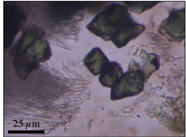
Abb. 5-19 Gruppe von idiomorphen Xenotimkristallen im Quarz bzw. neben Fibrolith
