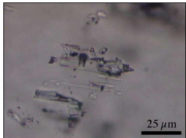
Abb. 5-13 Feste Aktinoliteneinschlüsse mit Hämatitphase (schwarz) im Diopsid
