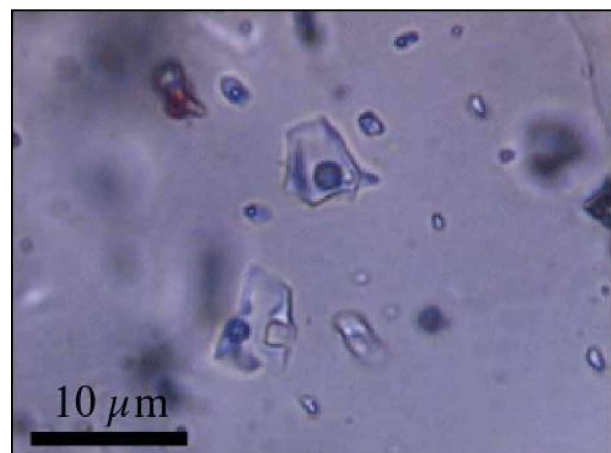
Abb. 5-77 Komplexe Einschlüsse mit Salzkristall
