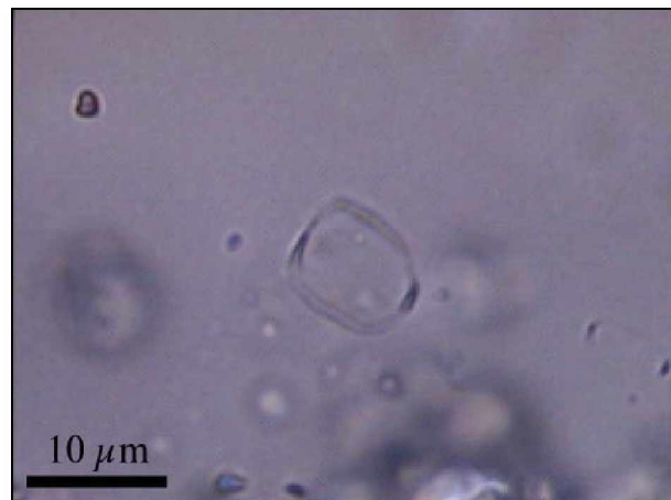
Abb. 5-8 Ringtextur eines FI im Quarz
