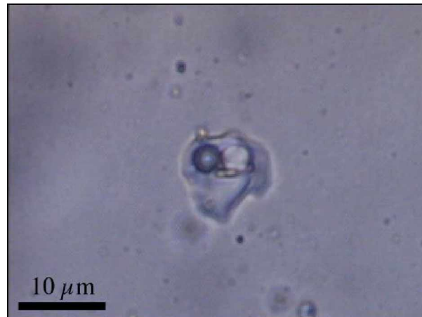
Abb. 5-24 Mehrphasiger Einschluss im Quarz
