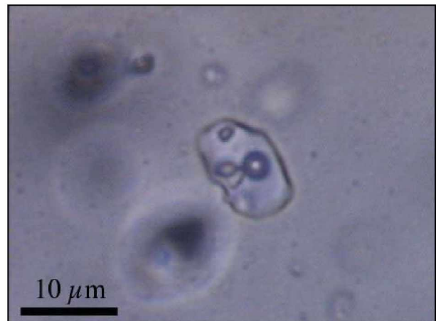
Abb. 5-23 Mehrphasiger Einschluss im Quarz
