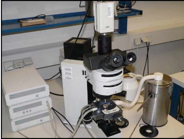
Abb. 3-5 Heiz- Kühltisch (LINKAM MDS 600) mit angeschlossenem Polarisationsmikroskop
