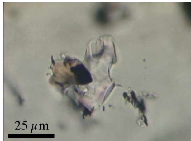
Abb. 5-63 Mehrphasiger Einschluss ohne Gasblase im Diopsid
