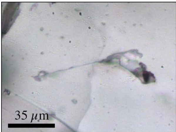
Abb. 5-97 Idiomorpher Quarzkristall im Diopsid
