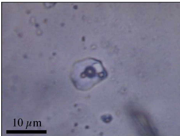
Abb. 5-22 Mehrphasiger Einschluss im Quarz
