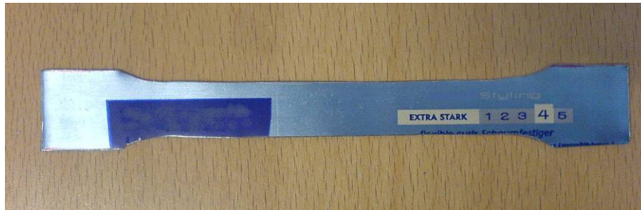
Abbildung 4.11: Zugprobe aus lackiertem und unverformtem Dosenmaterial
