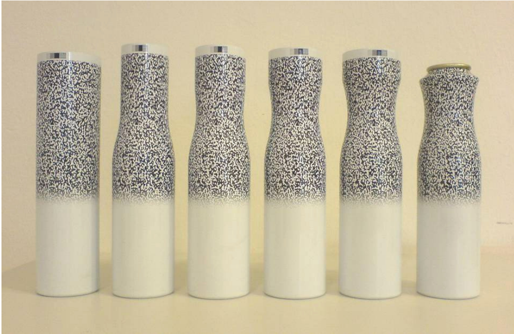
Abbildung 4.17: Dosen mit Musteraufdruck in unterschiedlichen Umformstadien
