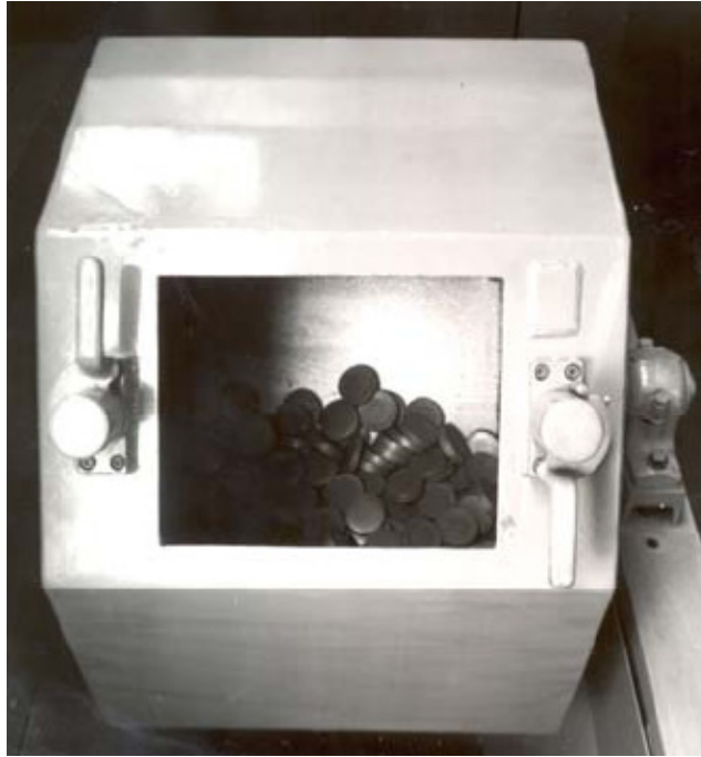
Abbildung 2.19: Trommel zum Schmierstoffbeschichten von Aluminiumbutzen (Schuler AG) [1]
