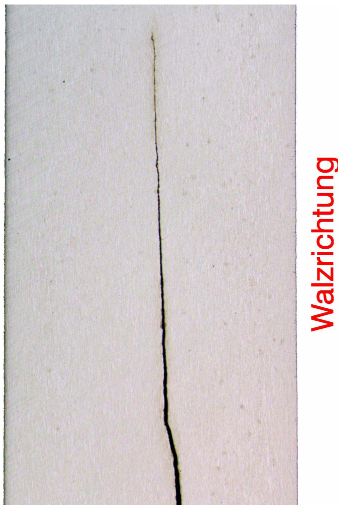
Abbildung 5.1: Längsschliff des Drahtes: Das Schliffbild zeigt den von der Mitte des Drahtes ausgehenden und gegen die Walzrichtung nach außen laufenden Riss mit einer 25-fachen Vergrößerung [25].
