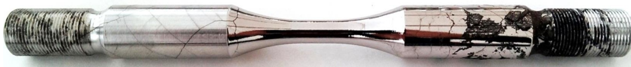
Abbildung 4.31: Schwingprobe vom Werkstoff P556-27%KV mit Spannungsrissskorrosion nach 7 Tage Auslagerung unter Prüfbedingung 5 (43 Gew.-% CaCl 2 , pH 4, 120 °C)
