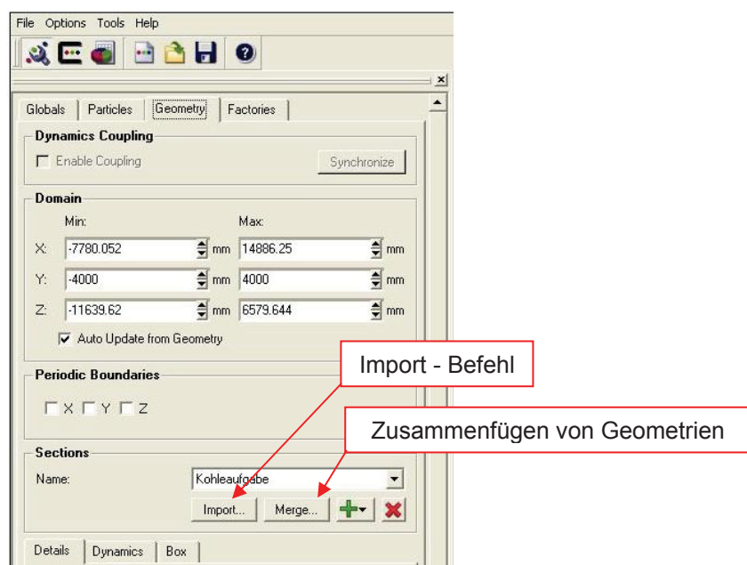
Abbildung 31: Software EDEM: Importieren der Bauteilgeometrie
