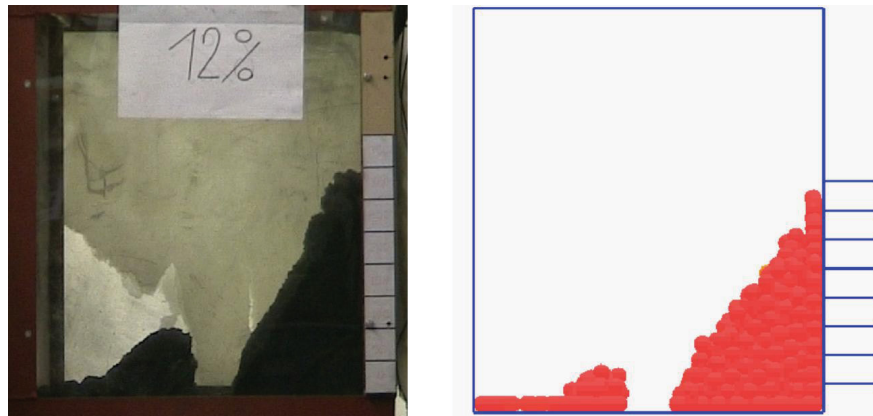
Abbildung 62: Schüttgutgeometrie nach Öffnen der Schüttgutklappe (Duracorr 300)-Schüttgut 12% Feuchte 118
