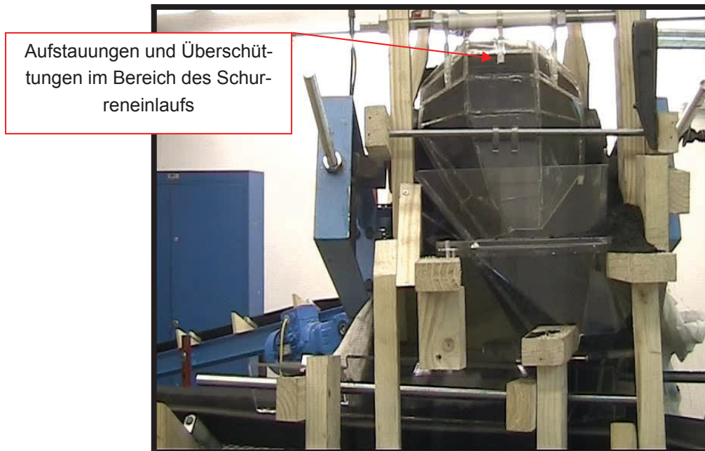
Abbildung 89: Versuch 2 mittels Kohle - 30 Sekunden nach Inbetriebnahme
