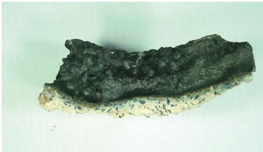
Abbildung 29: Draufsicht auf die durch die Schlacke angegriffene Fläche in das Feuerfestmaterials
