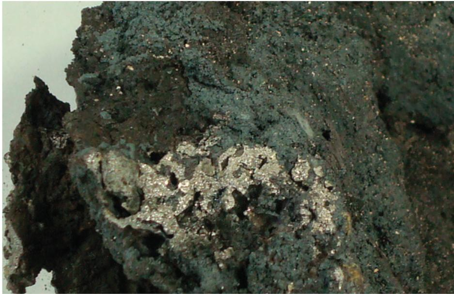
Abbildung 49: Bruchfläche des Ansatzes aus Versuchsserie 2
