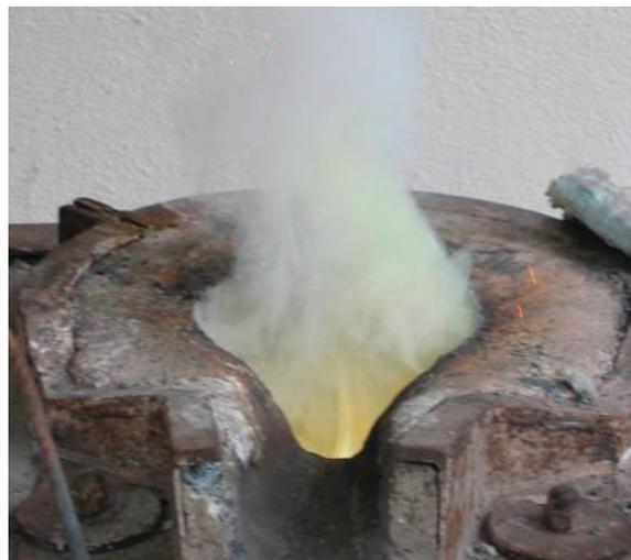
Abbildung 19: Auftreten des Zinkrauchs
