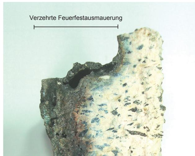
Abbildung 28: Schnitt durch die Feuerfestausmauerung auf Höhe der Schlackenlinie
