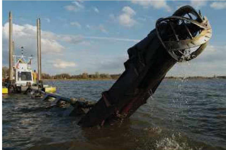
Abbildung 4: Baggerkopf mit eingebauten Cutter [10]
