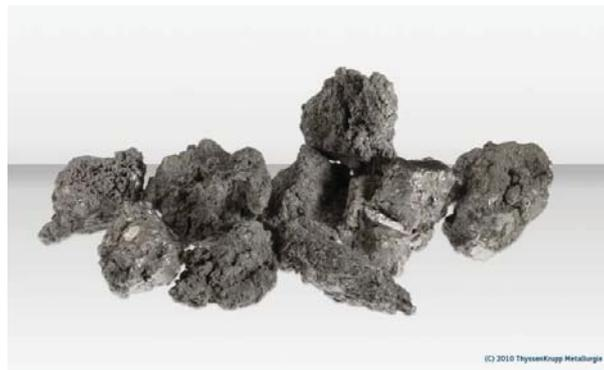
**Abb. 3.2:** Titanschwamm [6]
