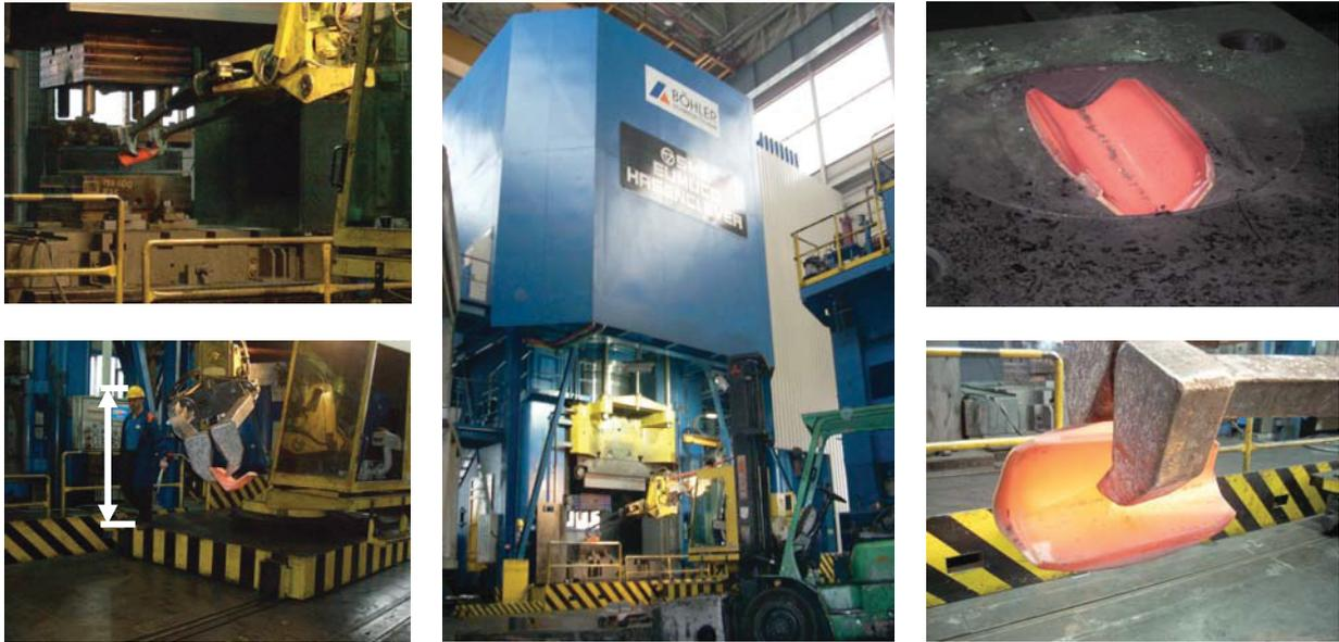
Abb. 4.8: Schwenkvorrichtung mit V-Shape (li), 350MN-Spindelpresse(m), fertiges V-Shape (re)
