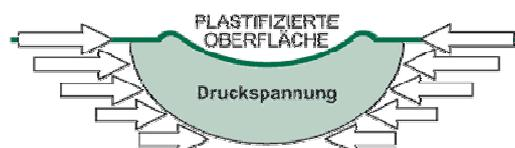
**Abb. 3.12:** Entstehung von Druckeigenstressung beim Kugelstrahlen [27]
