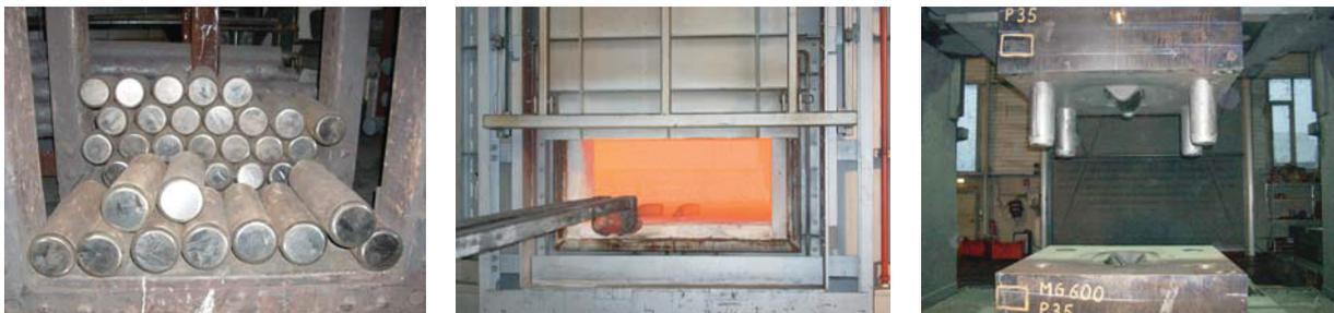
Abb. 4.7: Rohmaterial (li), Drehherdofen (m), Gesenk (re)
