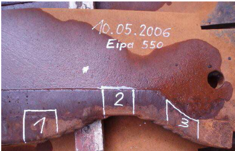
Abb. 34: Verschlissener Rostbalken mit Probenkörperbezeichnung
