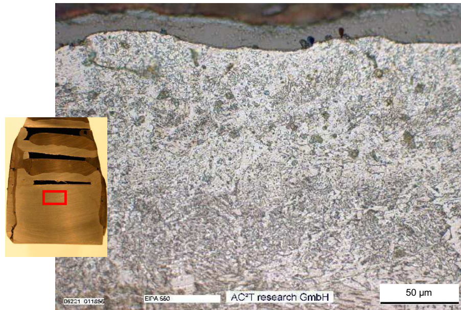
Abb. 39: Position D, Oxidschicht auf Rostbalkenträgermaterial, 500x (Ätzung: Nital 5%, 5s)
