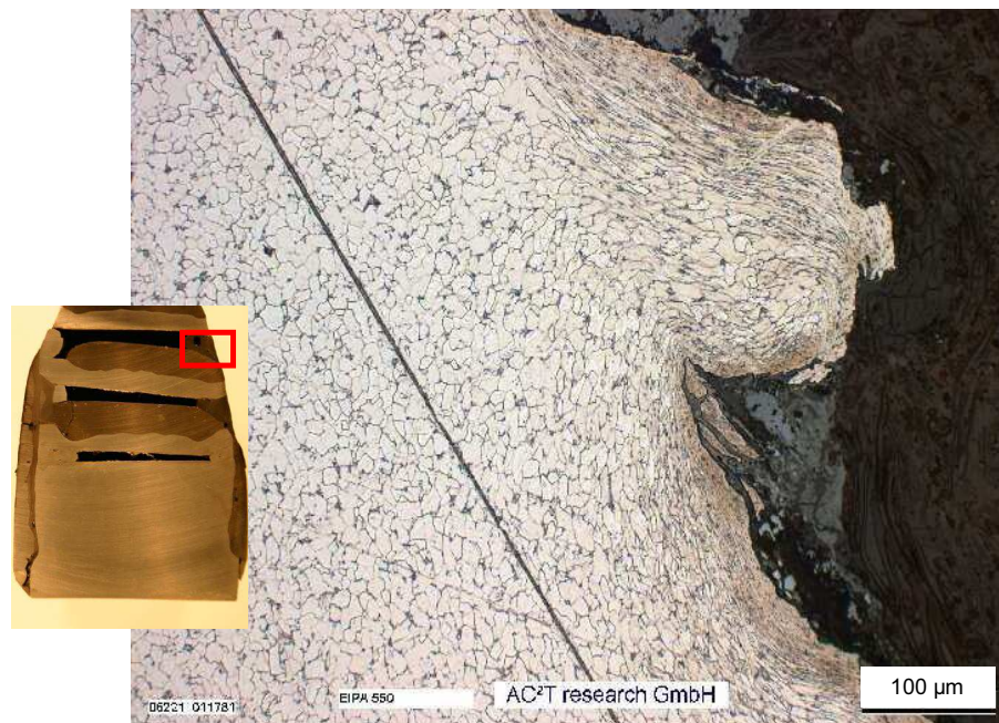
Abb. 37: Position B, Schuppenbildung des freigelegten Substrats an der Rostflanke, 200x (Ätzung: Nital 5%, 10s)
