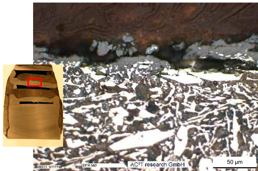
Abb. 38: Position C, selektiver Oxidationsangriff, 500x (Ätzung: Nital 5%, 10s)
