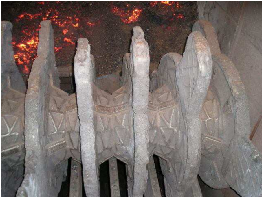
Abb. 2: Brecherrost unter dem Stachelbrecher; Abwurfzone mit Sinter im Hintergrund (Stillstand)
