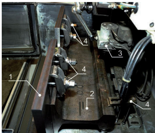
Abbildung 4.6: Schiene beim Drahterodieren: Die auf der Haltevorrichtung befestigte Schiene in der Drahterodiermaschine. 1) Haltevorrichtung, 2) Schiene, 3) Führung für den Draht, 4) Befestigung.
