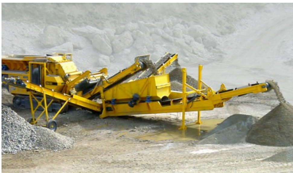
Abbildung 11: Mobile Brecheranlage kombiniert mit Siebanlage
