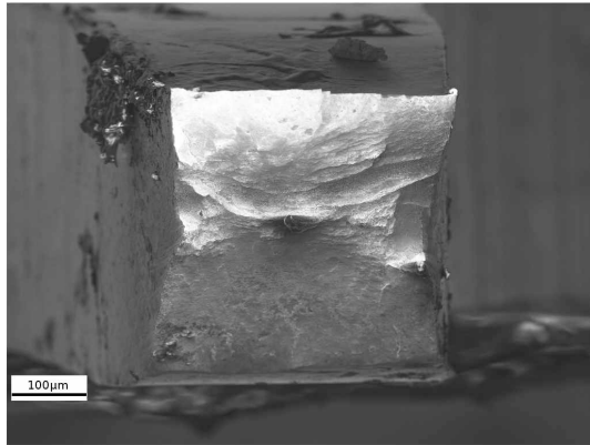
(a) REM-Übersichtsaufnahme der Bruchfläche einer Hälfte der Zugprobe mittels InLens-Detektor
