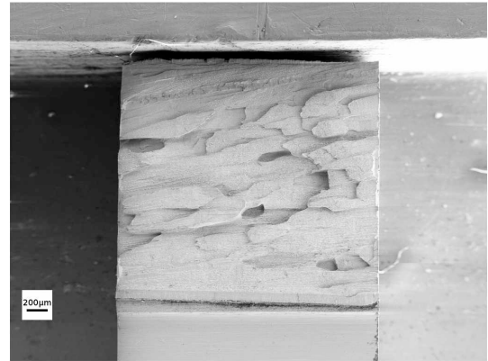
(b) REM-Übersichtsaufnahme der Bruchfläche einer Probenhälfte mittels Sekundärelektronen-Detektor
