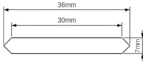
Abbildung 2.1.: Typische Abmessungen einer 30 mm Durchmesser HPT-Probe nach der HPT-Verformung.
