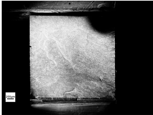
(a) REM-Übersichtsaufnahme der Bruchfläche einer Probenhälfte mittels InLens-Detektor
