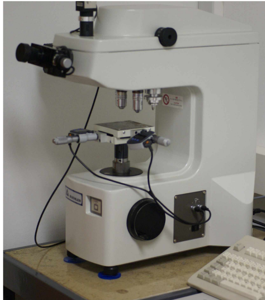
Abbildung 3.1.: Fotografie des verwendeten Härtemessgerätes MicroMet 5104 von Buehler.
