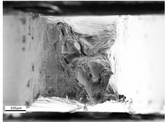
(b) REM-Übersichtsaufnahme der Bruchfläche einer Hälfte der Zugprobe mittels Sekundärelektronen-Detektor
