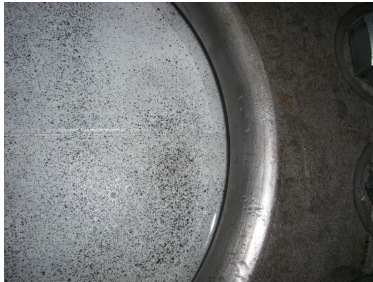
Abb. 4.9: Stochastisches Sprühmuster auf eingespanntem Tailored Blank.
