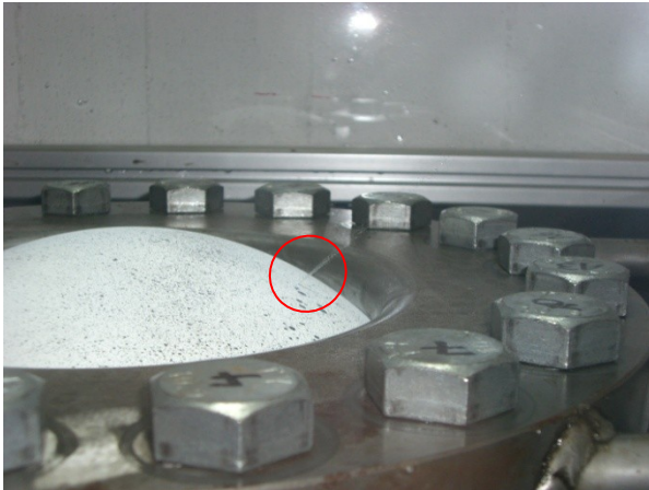
Abb. 5.27: VD06 mit austretendem Wasserstrahl.
