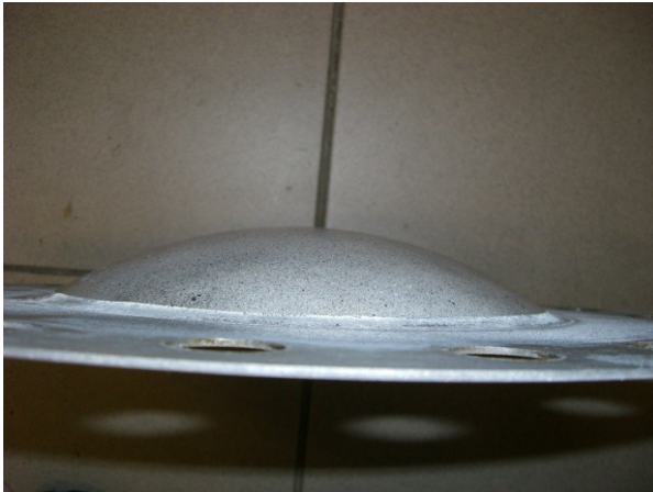
Abb. 5.37: Erreichte Tiefung bis zur Leckage bei VD08.
