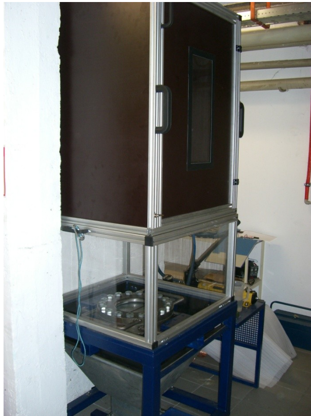
Abb. 4.3: Versuchsstand. Schutzeinhausung gegen Spritzwasser und eventuell herumfliegende Teile.
