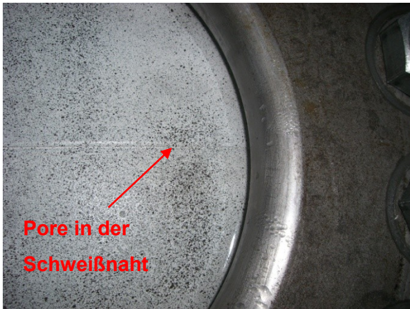
Abb. 5.22: Draufsicht VD05 mit Pore in der Schweißnaht.
