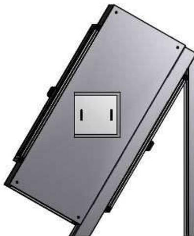
**Abbildung 46: Seitenansicht - Endkonzept der Zugprüfmaschine (schematisch).**
