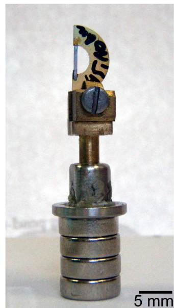
Abbildung 2.9.: Probenhalter der ID13 mit halbrunder Messingscheibe und geklebter Probe
