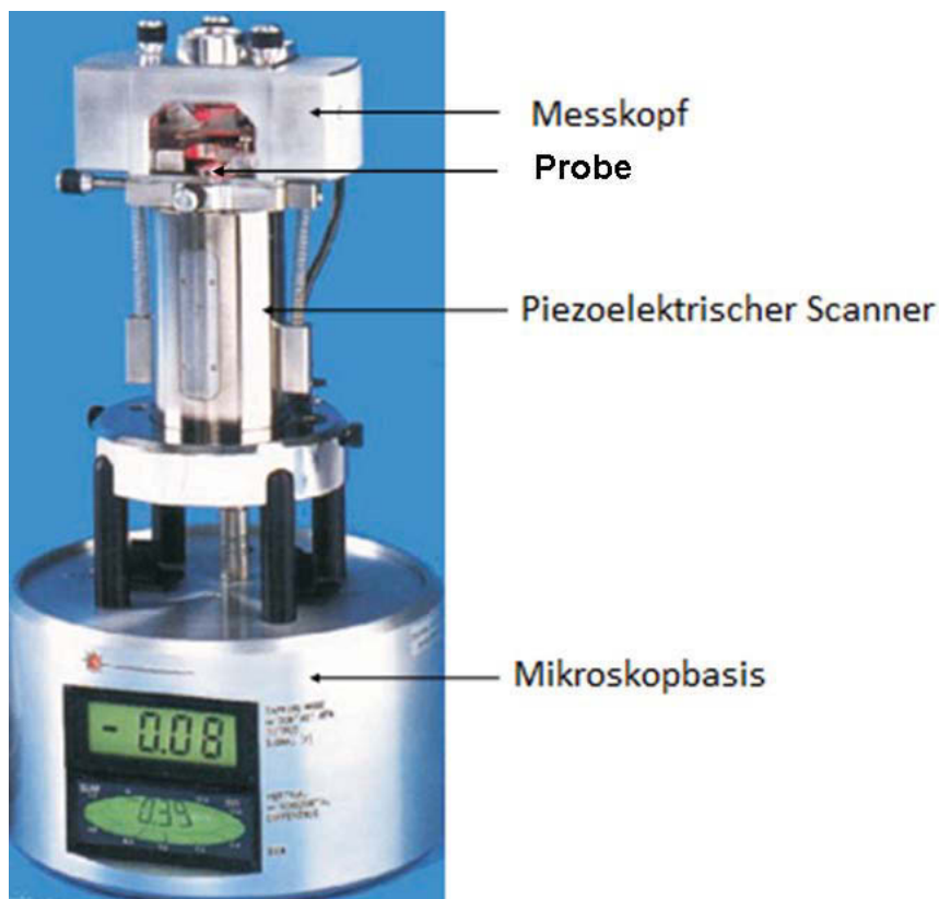
Abbildung 5: Aufbau Multi-Mode IIIa Rasterkraftmikroskop der Firma Digital Instruments-Veeco
